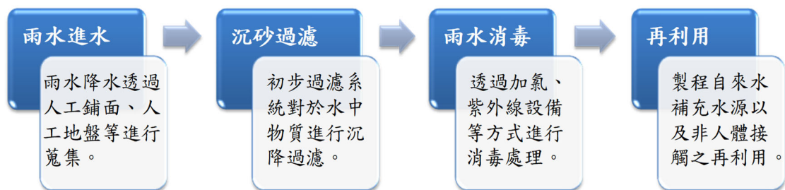
■ 圖 39 雨水回收流程圖
