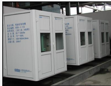
河川水混凝 (2,400 CMD)
