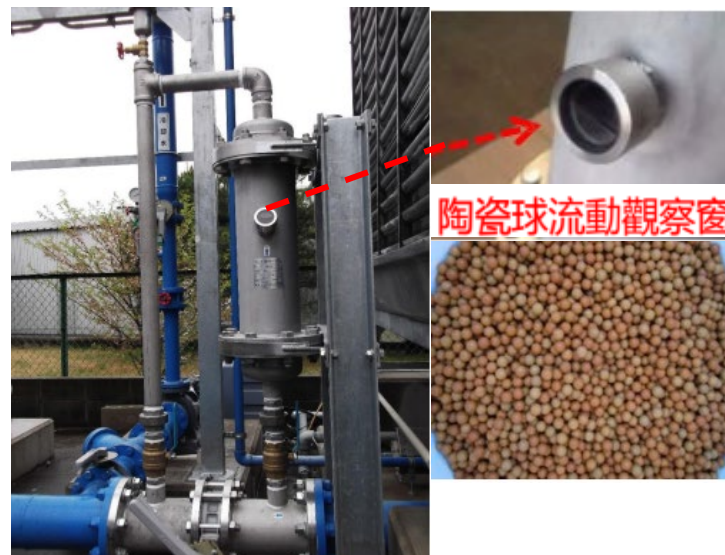
圖 14 陶瓷球處理系統理論
