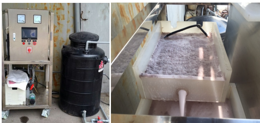
圖 33 電混凝處理系統實廠模組示意圖
