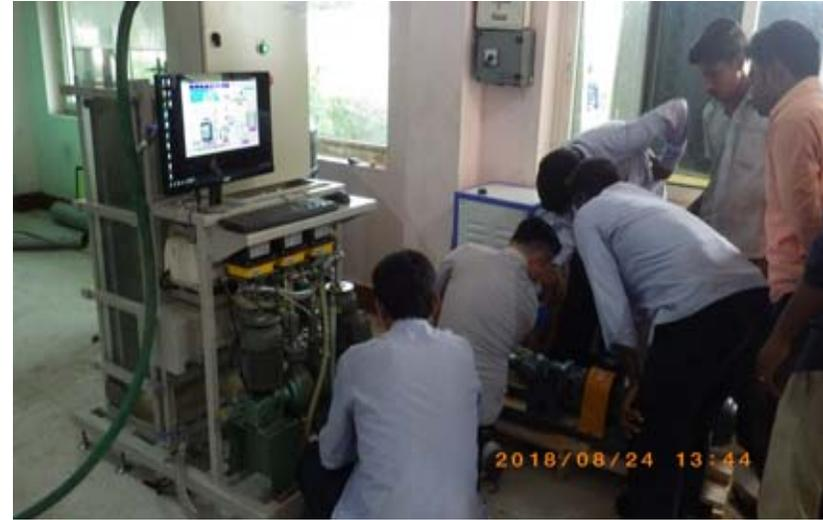
測試前進行完整的清水試車、測試後清洗後再做一次清水通量試驗，瞭解通量恢復狀況
