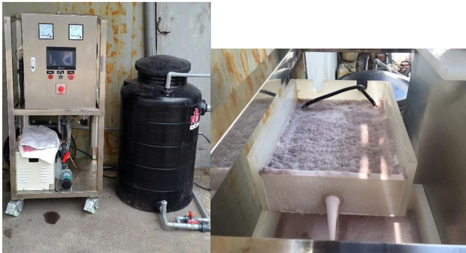
圖 31 電混凝處理系統實廠模組
