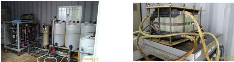
圖 33 倒極式電透析模組設備
