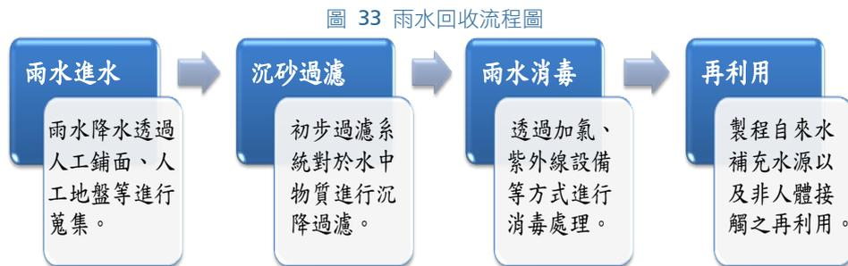
設計準則參考收集雨水處理設備與使用程度關係如表 17 所示，雨水截流系統設計值計算如表 18 所示，根據中央氣象局氣候分區相關氣象資料顯示，預估平均雨量、降雨概率規劃雨水利用設計量。
