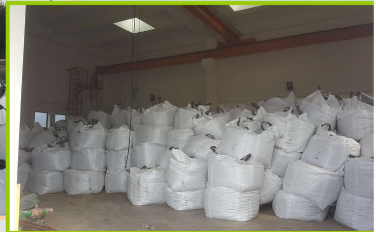
曬乾床溼污泥含水率約95%、裝袋後之乾污泥含水率<20%、減少重量超過90%
