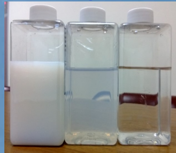
CMP研磨廢水 (濃縮液回收，產水回用)
